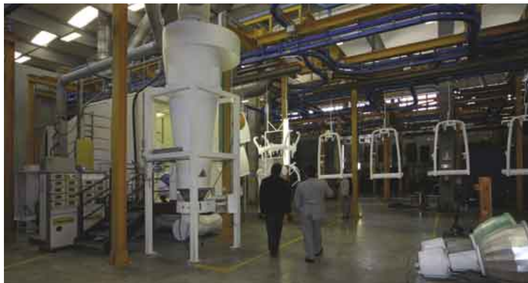
Fig 7 - I pezzi in uscita da una delle due cabine di verniciatura a polvere prima dell'ingresso nel forno di polimerizzazione.
