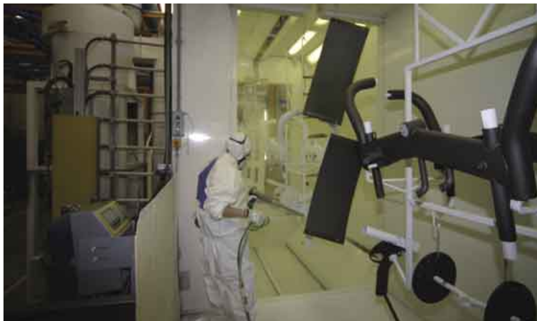
Fig. 11 - L'applicazione della prima mano di verniciatura a polveri, con il preritocco manuale.
