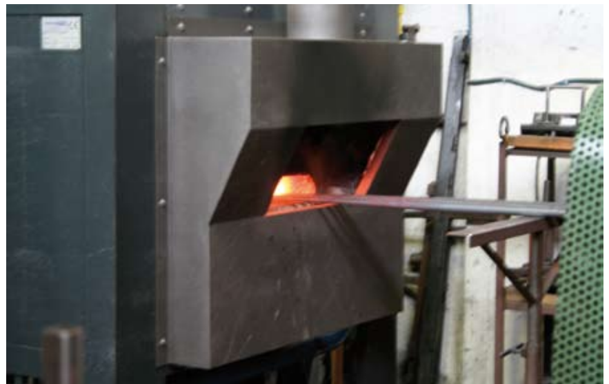
8 e 9 - In basso, due fasi della forgiatura e piegatura manuale delle verghe.
