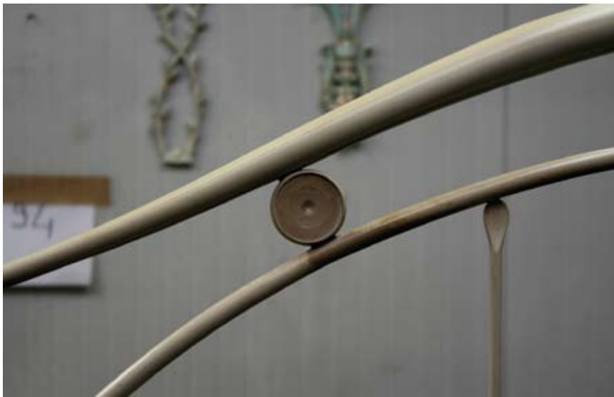
15 - Primo piano di uno dei punti critici per la verniciatura: i riccioli di una testata.
