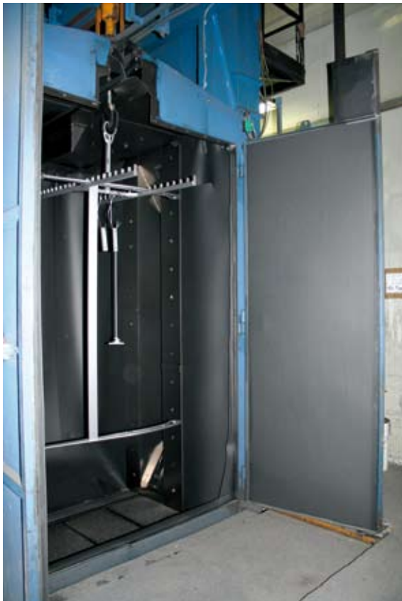
11 - L'ingresso della sabbiatrice automatica che prepara i pezzi alla successiva finitura.
