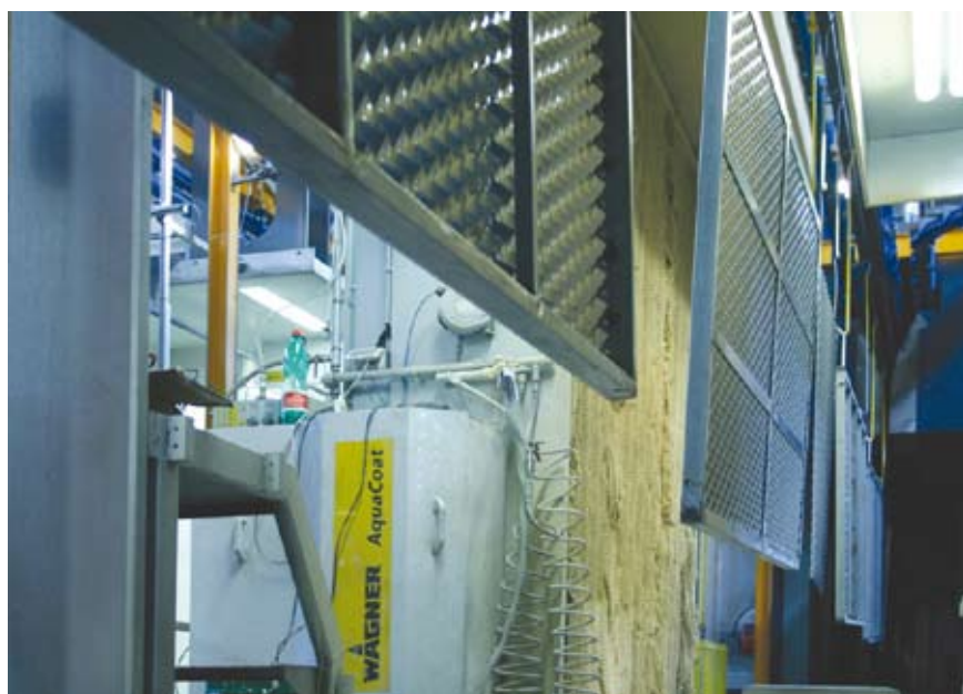
5 - Détail de l'application de poudres sur une grille ayant une forme complexe.
