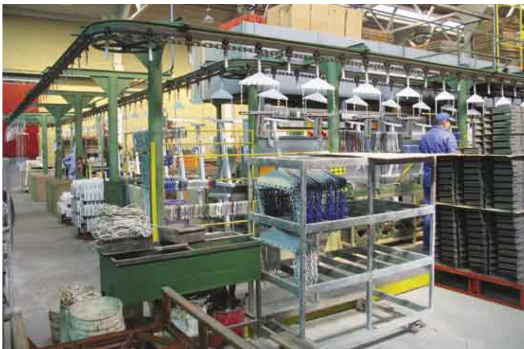
Fig. 6 - La zona di carico e scarico pezzi dell'impianto di verniciatura
