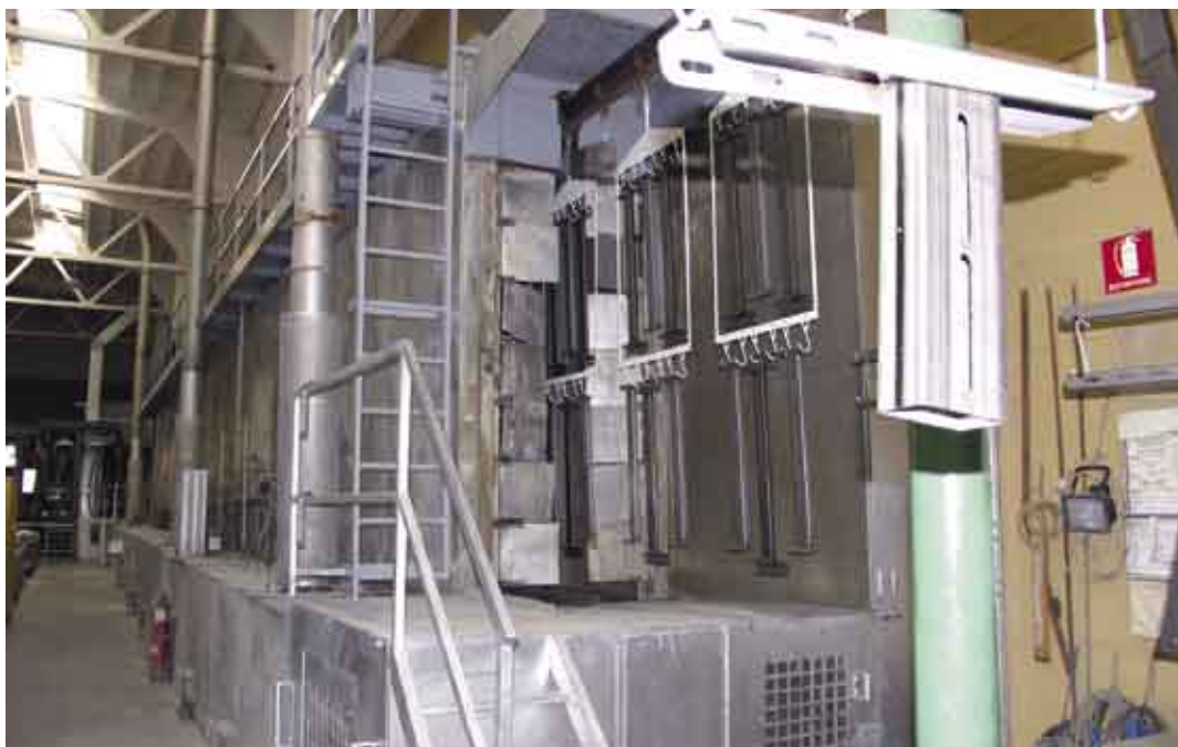
Fig. 6 - La zona di carico e scarico pezzi dell'impianto di verniciatura
