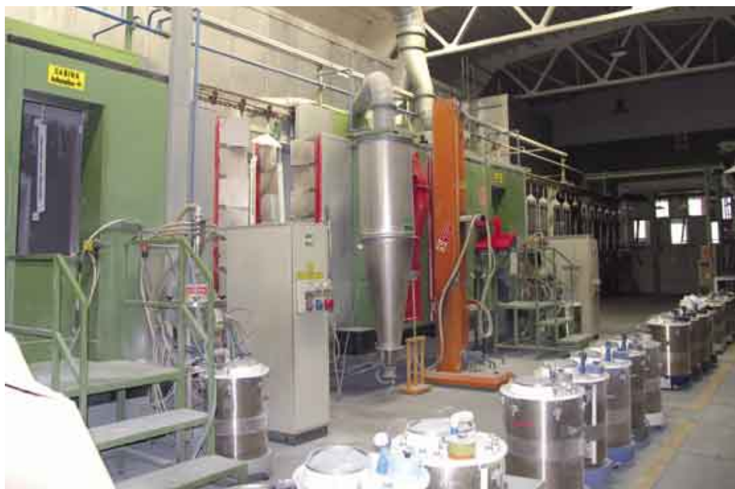
Fig. 8 - Panoramica della zona di applicazione polveri in automatico con recupero a ciclone
