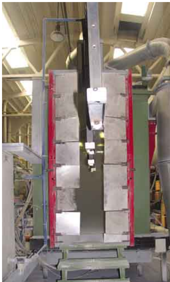
Fig. 10 - Particolare dell'applicazione polveri nella cabina automatica a mezzo di reciprocatori. Da notare il ridotto overspray grazie all'azione dell'Atimix
