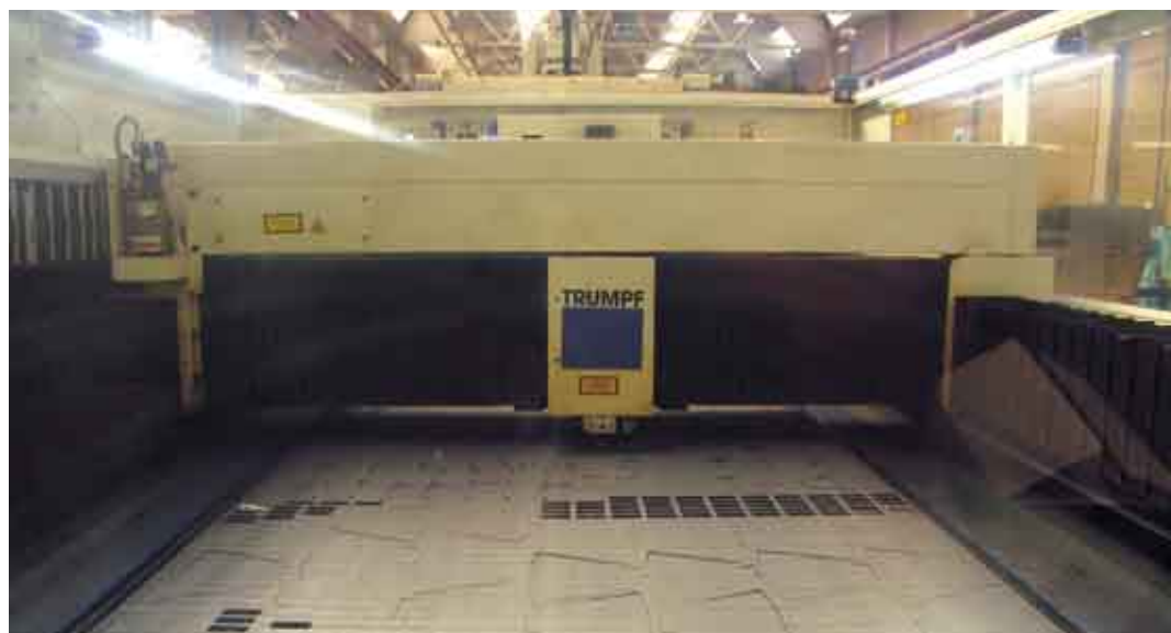
Fig. 4 - Una delle nuovissime macchine per il taglio laser della lamiera
