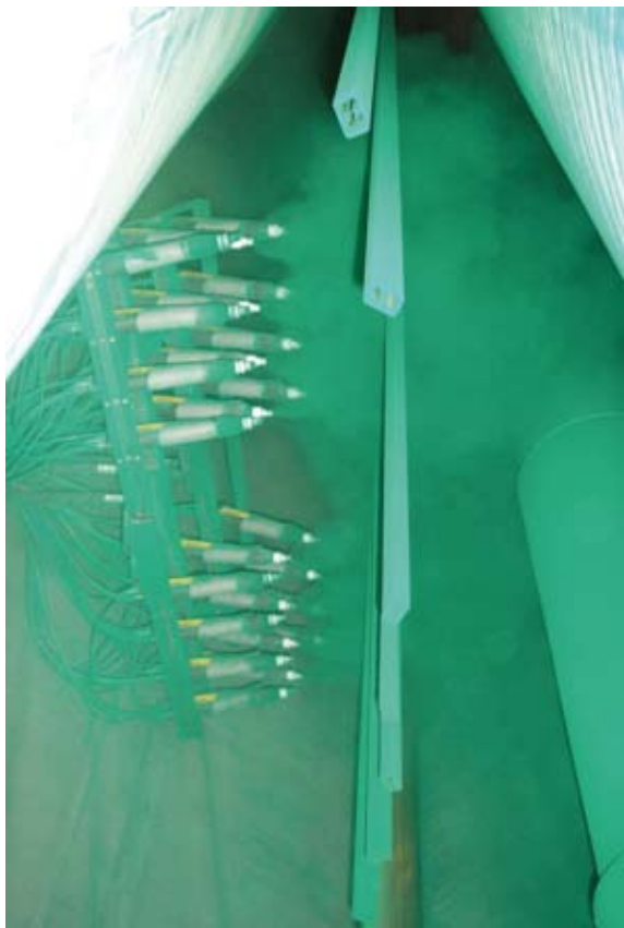
3 - Détail des pistolets de peinture de l'installation verticale installée chez la société française.
