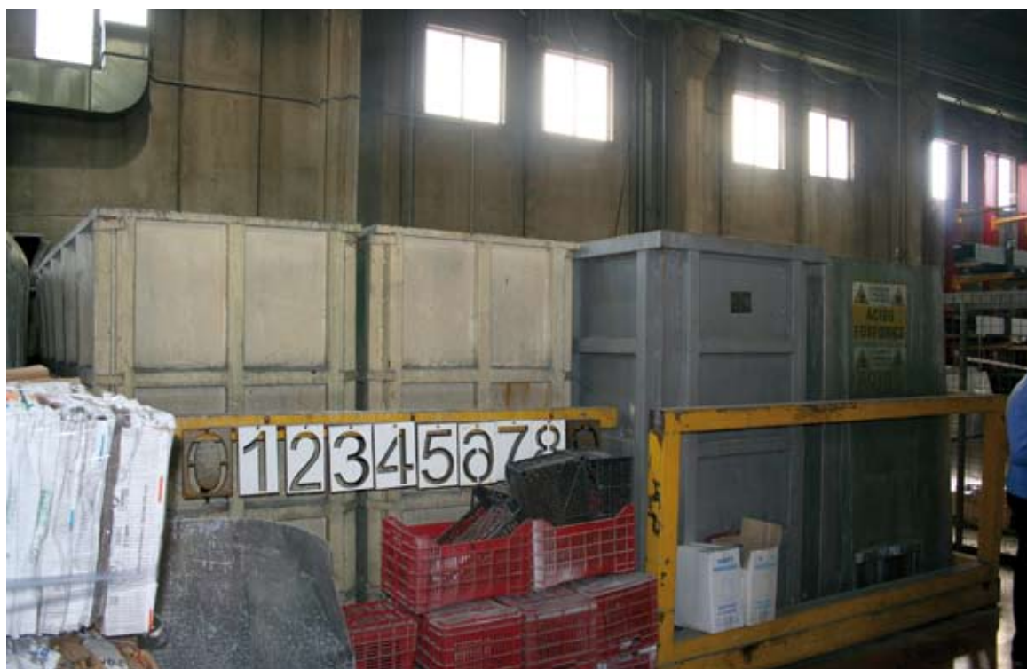
3 - Le vasche di pretrattamento ad immersione dello zinco a caldo.
