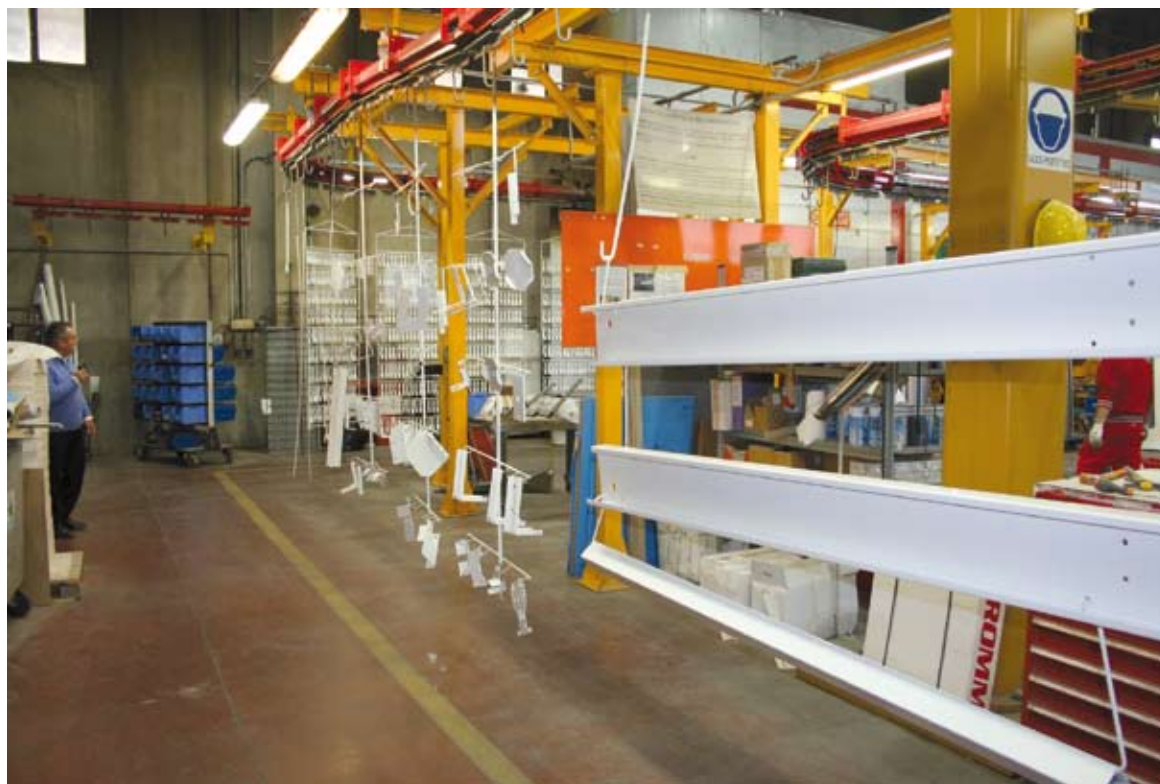
11 - La zona di raffreddamento dei pezzi verniciati: in questo caso si tratta di parti destinate a comporre dispositivi di montacarichi e ascensori.
