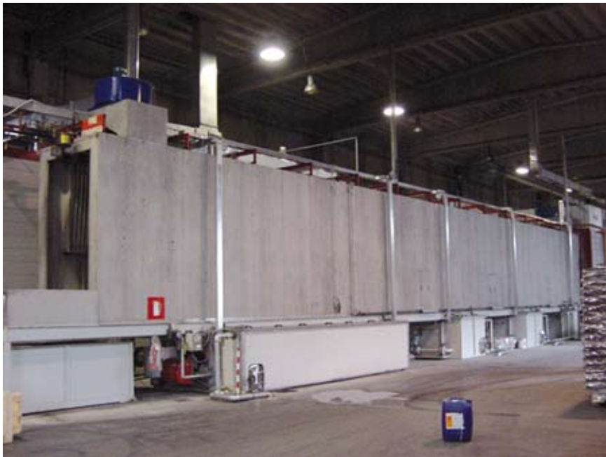
5 - L'ingresso dei manufatti (si tratta di parti di lampade di design) nel tunnel di pretrattamento.
