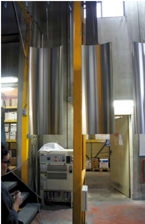
6 - Dopo l'asciugatura, i pezzi passano attraverso un dispositivo a fotocellula, di lettura delle dimensioni del manufatto per il calcolo della quantità di vernice a polvere da erogare.
