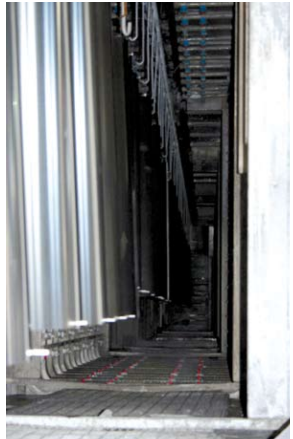
5 - L'ingresso dei manufatti (si tratta di parti di lampade di design) nel tunnel di pretrattamento.
