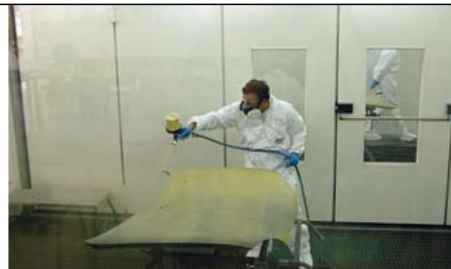
Nel processo di verniciatura si verificano sfregamenti che originano cariche statiche di bassa entità, che causano disturbi all'applicazione del prodotto verniciante
