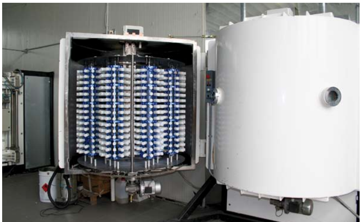
12 - Il reattore, fotografato aperto, per la metallizzazione di manufatti plastici alla Eurocoating di Mezzago (Mi).
