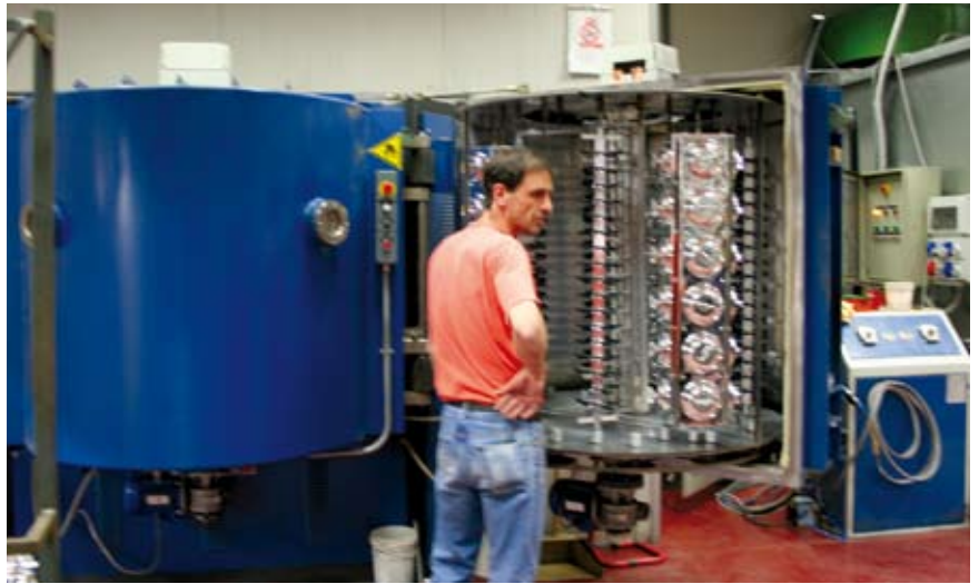
2 - Il reattore, in alto, fotografato aperto, per la metallizzazione dei pezzi plastici.
