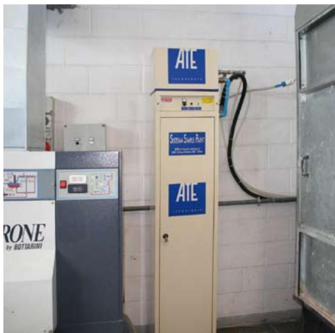
14 - La macchina Simple Paint che asserva quattro cabine di verniciatura.
