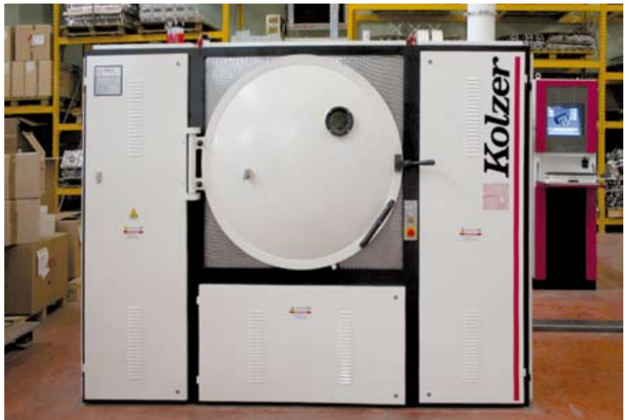
3 - Una macchina per lo sputtering, una tecnologia alternativa alla metallizzazione tradizionale, che la Maxpla sta testando per abbattere l'impatto ambientale delle proprie attività di finitura.
