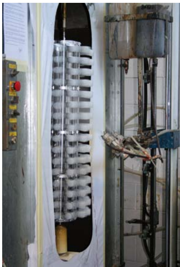
13 - La cabina per l'applicazione in massa della finitura trasparente con vernici a basso impatto ambientale.
