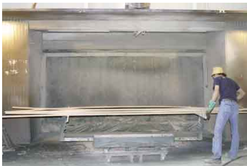
5 - La cabina manuale di verniciatura all'acqua dei serramenti.
