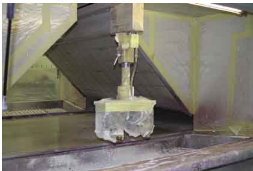
7 - Particolare dell'interno della verniciatrice automatica con il gruppo di spruzzatura: è visibile la pulizia dell'impianto.
