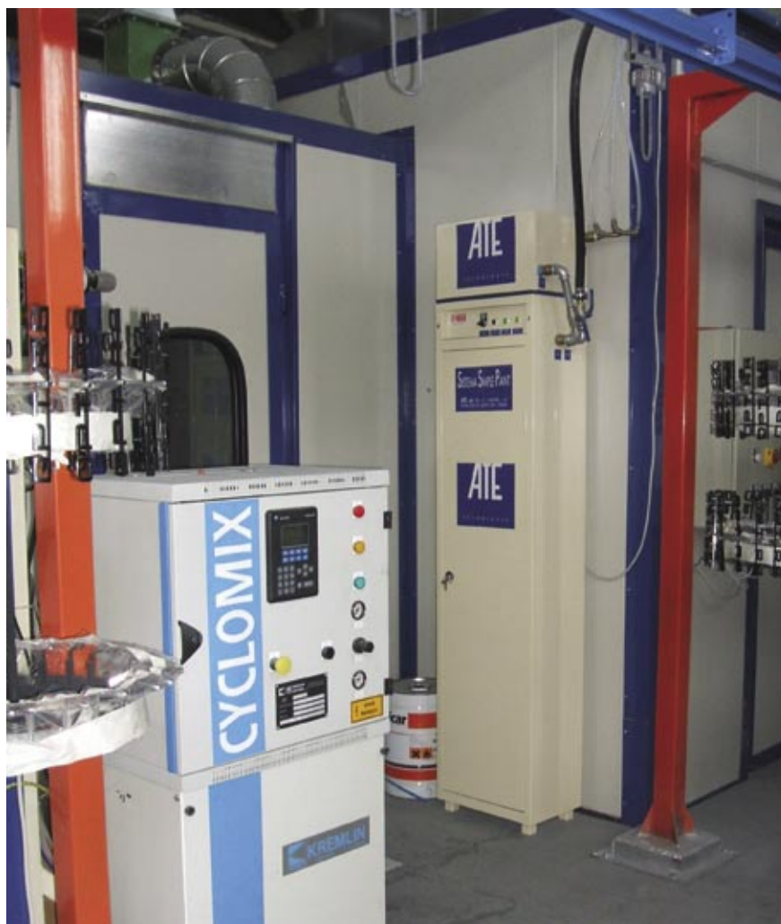
Fig. 2 - L'apparecchiatura Simple Paint collegata alla cabina di verniciatura a liquido di manufatti plastici.
