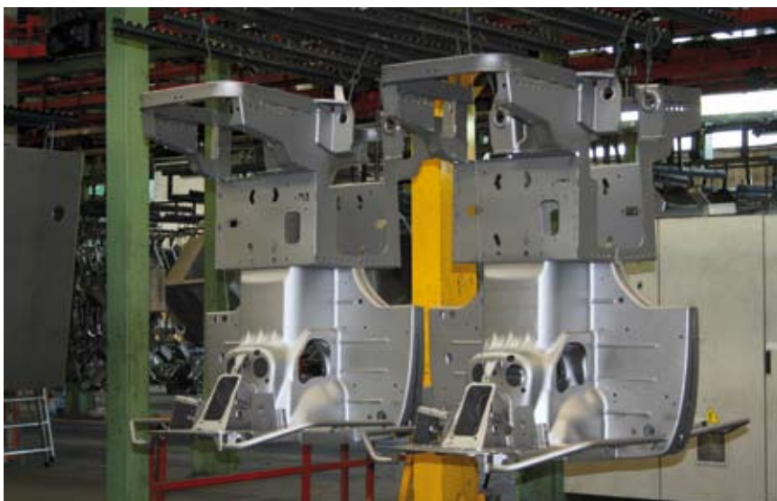
3 - Due telai per cabine appesi sull'impianto cataforesi + polveri.
