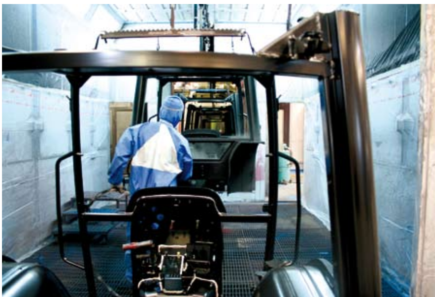
4 - L'interno di una delle cabine di applicazione polveri su cabine di trattore.
