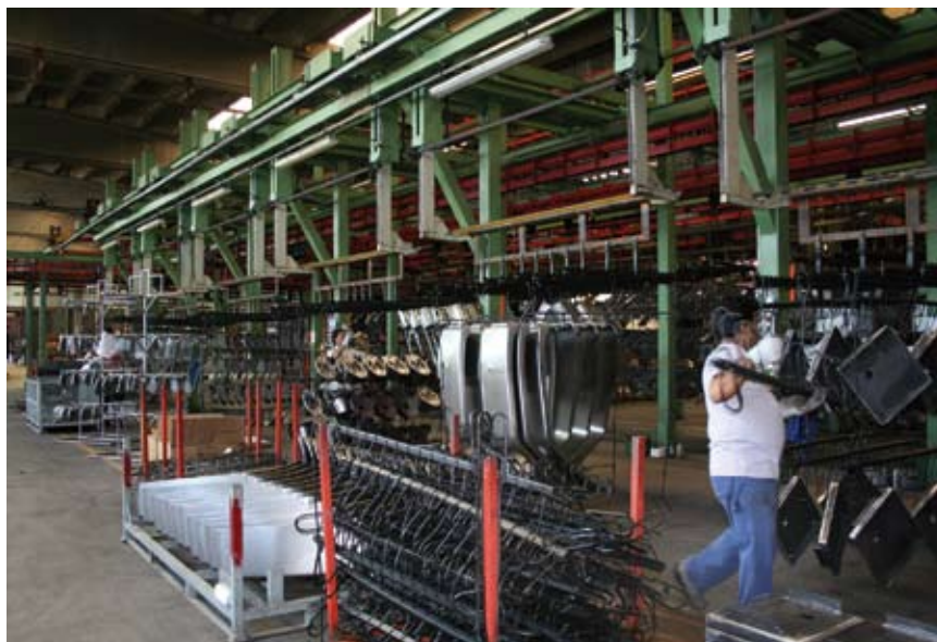
5 - Vista generale della zona di carico dell'impianto cataforesi + polveri.
