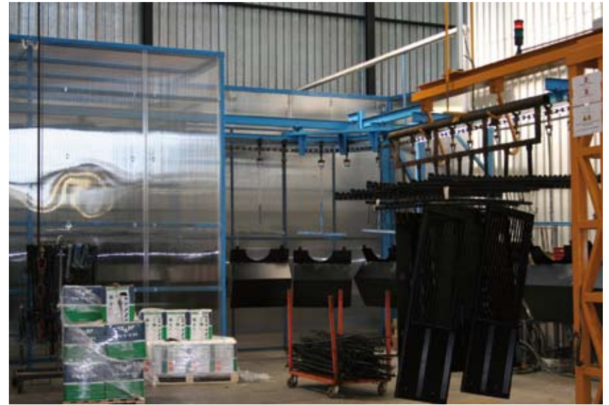
12 - La cabina di verniciatura a polveri automatica dell'ultimo impianto.
