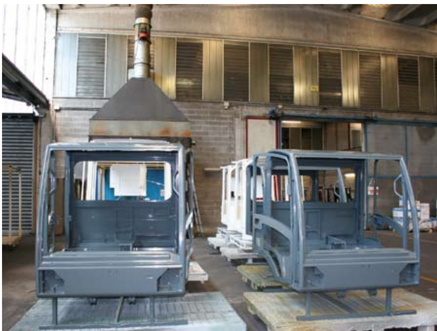
9 - Alcune cabine monolitiche di grandi dimensioni, verniciate a polveri, in uscita dall'impianto manuale.
