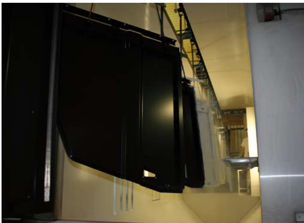
15 - Particolare dell'applicazione di polveri su componenti per trattori: è visibile il ridotto overspray e la concentrazione su pezzo del getto di polveri in uscita dalla pistola, garantiti dall'Atimix.
