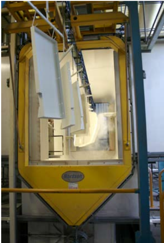
12 - La cabina di verniciatura a polveri automatica dell'ultimo impianto.
