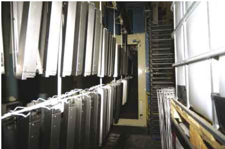
Fig. 7 - I pezzi all'ingresso del tunnel di pretrattamento
