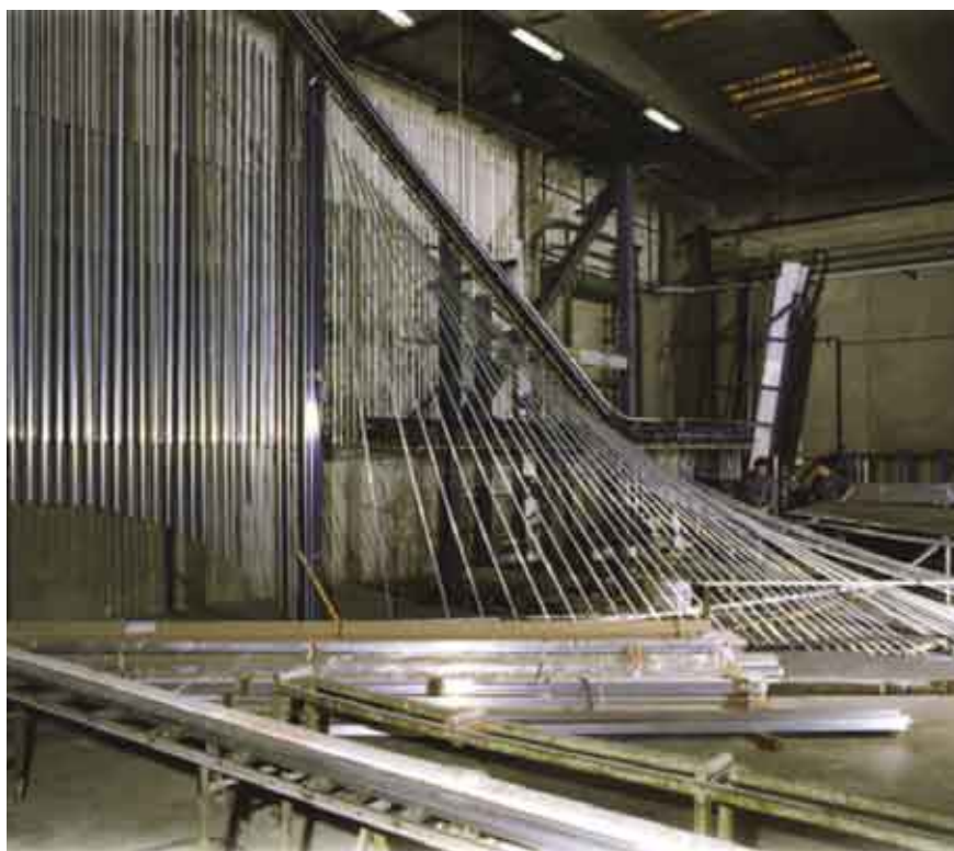
Fig. 2 - L'impianto di verniciatura in verticale di profilati in alluminio: particolare della zona di scarico
