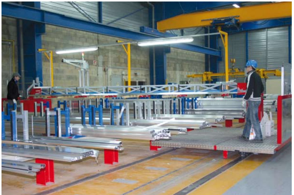
10 - La macchina che smista i pezzi provenienti dall'esterno nelle zone di competenza.
