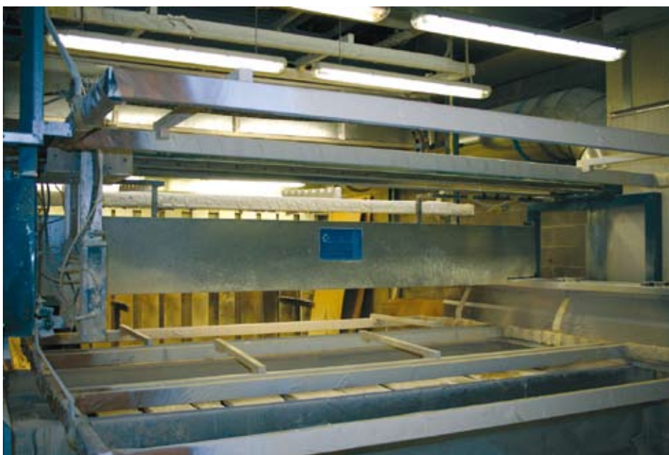
8 - La verniciatrice automatica per porte installata dalla Colocresi.
