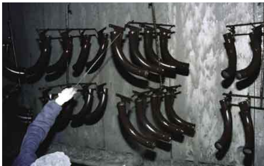
Fig. 2 - Una delle quattro cabine di verniciatura a velo d'acqua collegate al sistema Atimix
