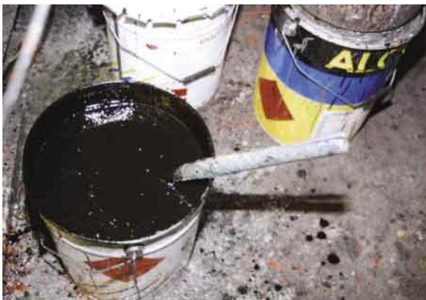
Fig. 6 - Particolare del prodotto verniciante pronto all'uso: è ben visibile la maggior densità del prodotto dovuta ad una minore quantità di diluente necessaria per l'utilizzo finale
