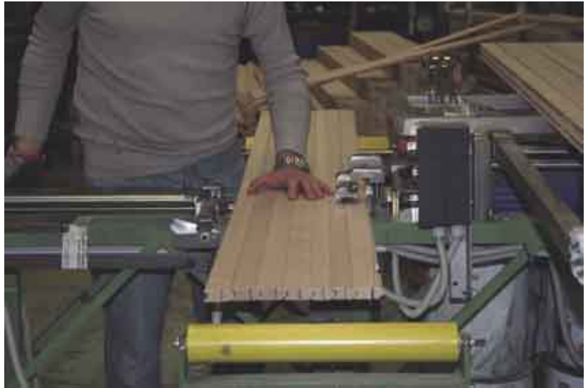
9 / 10 - Due fasi della produzione delle persiane dal legno grezzo all'anta incernierata.
