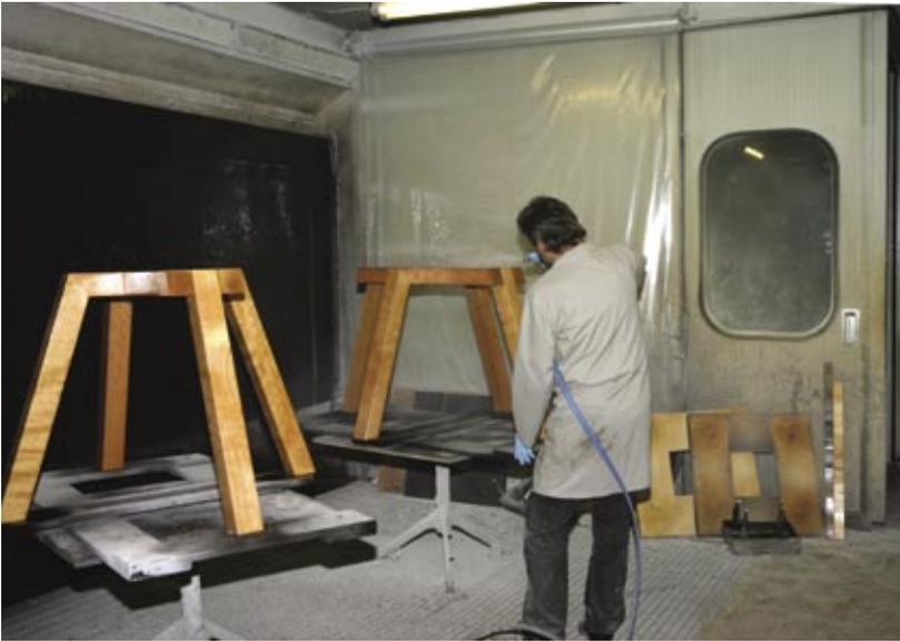
molteplici interferenze dell'elettricità statica anche quando non si utilizzano sistemi d'applicazione elettrostatici, per esempio quando si utilizzano sistemi misto aria, e che possono pregiudicare la qualità finale della fase di finitura, complicando la distensione corretta del film applicato, la sua uniformità, l'adesione sul supporto, oltre che creare quote aggiuntive d'*overspray*, con un antieconomico dispendio di vernice.
