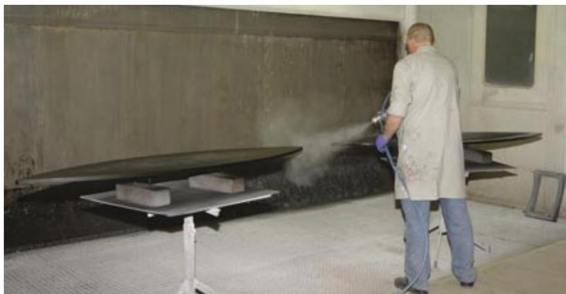
di verniciatura sono nettamente migliorate, perché in cabina si sviluppa meno fumo e le operazioni di pulizia di cabine e apparecchiature è più veloce.
